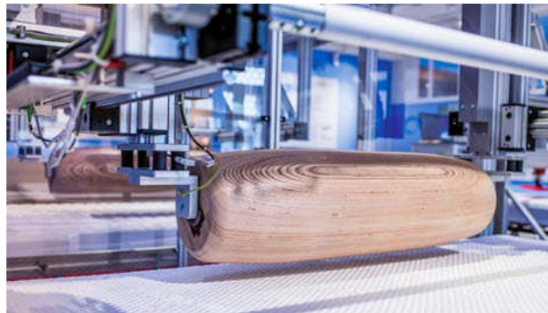
Testování mechanické odolnosti. Simulace životnosti matrace maximálním zatížením v nejexponovanější části matrace válcováním.
